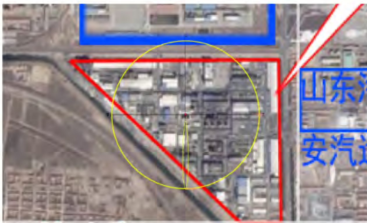
图 6.6-4 氯化氢污染事故最常见气象影响区域图（红线：终点浓度 1；黄线：终点浓度 2）
